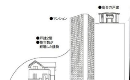
※必要給水圧力0.05MPa(10L/分流動時)従来のタンク式便器
